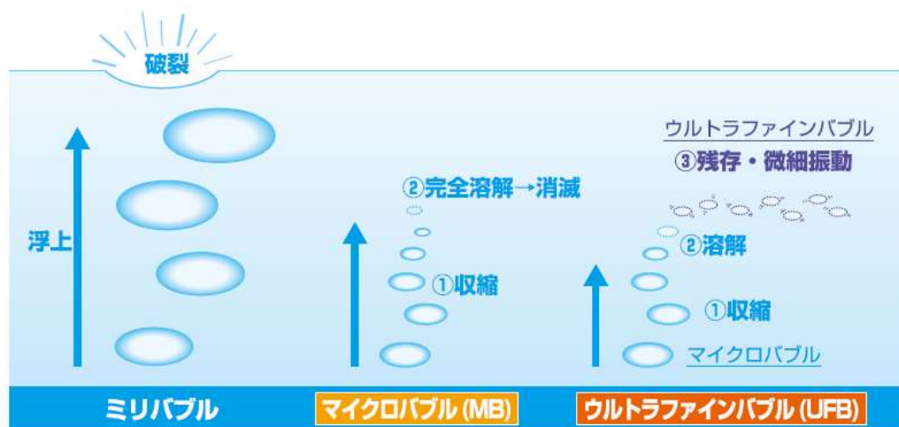
図1 ファインバブルの生成プロセス 出典) 一般財団法人ファインバブル産業会資料等を参考に環境テクノス作成
